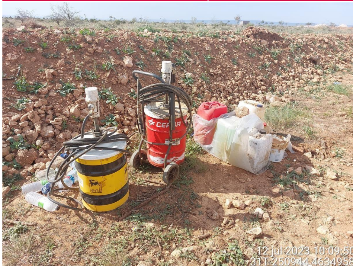
Imagen 1. Depósitos y cubos con grasa sin protección en el suelo en SC1.
